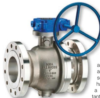
Instalada em válvulas de bitolas maiores, onde o torque de acionamento é maior, a caixa de redução oferece mais conforto ao operador por exigir menor esforço do que a alavanca no acionamento manual, além de ser uma solução em locais onde há pouco espaço para a operação da válvula, tanto fisicamente quanto ergonomicamente.
