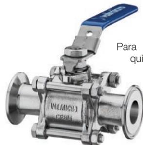
Para aplicações mais exigentes (indústria química, farmacêutica, alimentícia, etc.) que necessitem também acoplamentos rápidos, a Lupatech Valmicro oferece eletropolimento e extremidades tipo "Clamp" para suas válvulas, otimizando o tempo de montagem e desmontagem e facilitando as operações de limpeza da linha.
