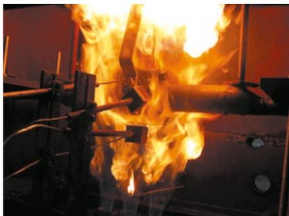
Após o teste a válvula deve ser operada, pressurizada e ainda capaz de reter pressão.
