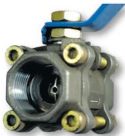
A Lupatech Valmicro oferece uma solução simples, mas que pode evitar problemas operacionais. Trata-se de válvulas providas de esfera com furo de alívio a montante. Na posição fechada, há um furo na esfera comunicando a câmara da válvula com o lado de alta pressão. Assim qualquer acréscimo de pressão na câmara, será imediatamente descarregado para a tubulação a montante, aliviando a pressão no interior da válvula.
